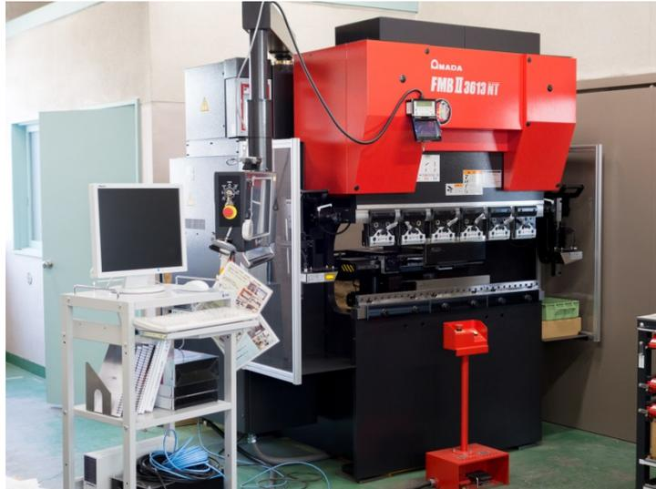
図 2-1-3-2 曲げ加工機（プレスブレーキ）外観
