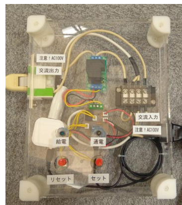
図 7 自動復帰回避装置の完成写真
