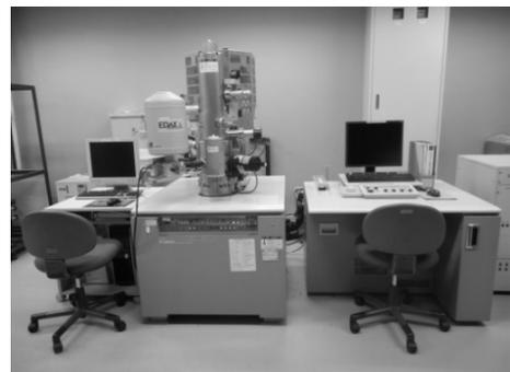
図 2 電界放出型走査電子顕微鏡
