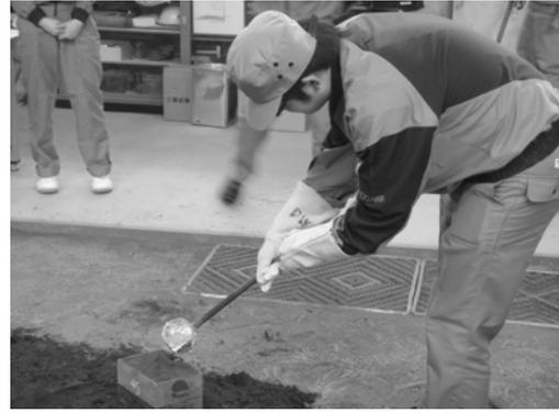
図4 亜鉛の鋳込み作業
