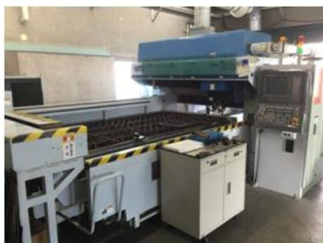
図2 レーザー溶断機
