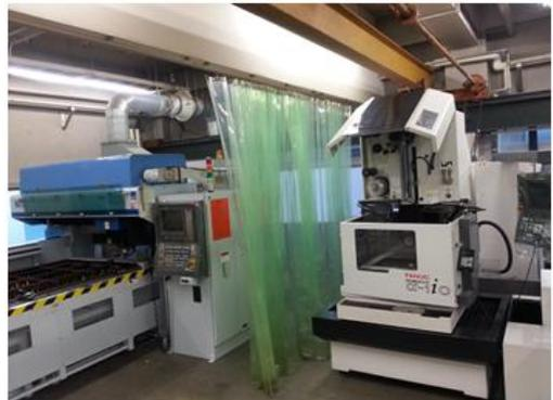
図4 レーザー溶断機・ワイヤー放電加工機
