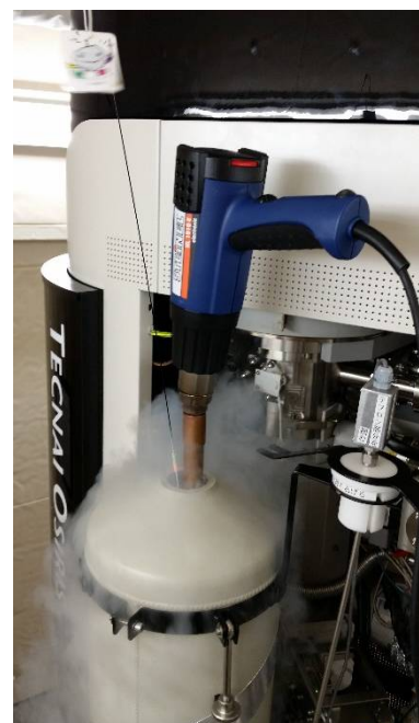
図 5 液化窒素強制蒸発作業
