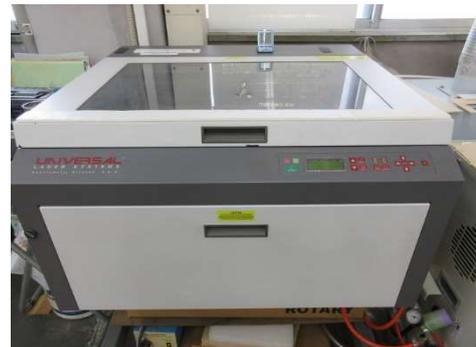
図1 レーザー彫刻機
