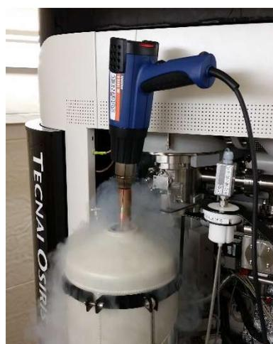
図 1 保守管理業務の一例（FE-S/TEM の液体窒素タンク内をヒートガンで蒸発させる作業）
