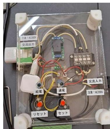
図6 ベーキングシステム自動復帰回避装置
